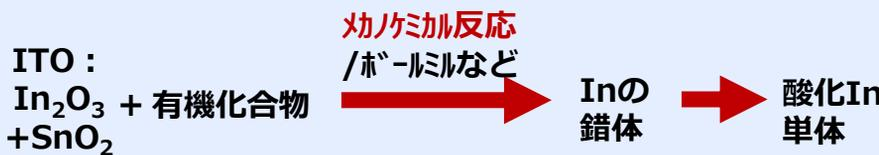
図1. 本発明の分離方法：ITOからメカノケミカル反応（固相反応）でInを分離
