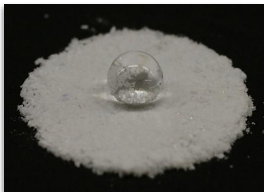
Fig. 1 開発したPCP結晶粉末の上に 置いた水滴（接触角 152^\circ ）
