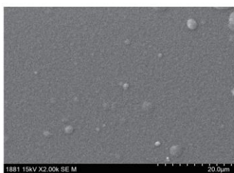
図1 本方法で作製したCrCoNi MEAめっきの表面二次電子像
