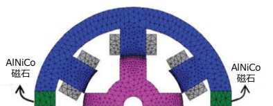
図1. 本発明に用いるSRMの構造 (上半分)
