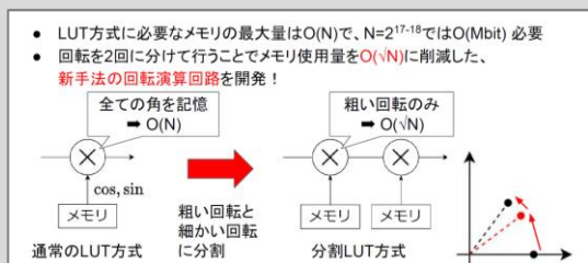
◀図1.FFT回路設計におけるメモリ使用量削減方式
